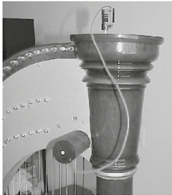
6. Si le Rod-tuner se met à sonner quand la pédale de La est en position bécarre, le câble doit être raccourci. Pour avoir accès au dessous du socle, penchez la harpe en arrière et faites-la reposer sur un support doux, comme un fauteuil ou une banquette.
