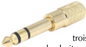
Un câble jack stéréo se distingue par ses deux anneaux sur l'embout, ce qui signifie qu'il y a trois connexions: l'une pour la gauche, l'autre pour la droite et la dernière pour la masse. Vous trouverez ce type de prise jack au bout de votre câble de casque. Il existe d'ailleurs deux tailles de prises jack. Pour les instruments de musique, on utilise presque uniquement le jack 6.35 (qu'on
