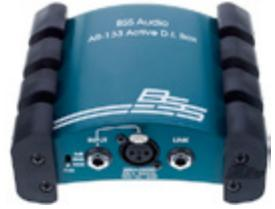
Le type de câble le plus répandu chez les professionnels du son est le câble XLR qui comprend 3 fils : la masse, le signal et le signal avec la phase inversée. C'est pour cela qu'on appelle ce signal « symétrisé ». Grâce à cette particularité, le signal peut être transmis sur de plus longues distances et il sera mieux isolé et protégé des parasites extérieurs, notamment liés aux systèmes de lumière.
